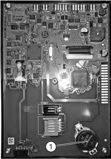
TFT-näytön piirilevyn takapuoli
